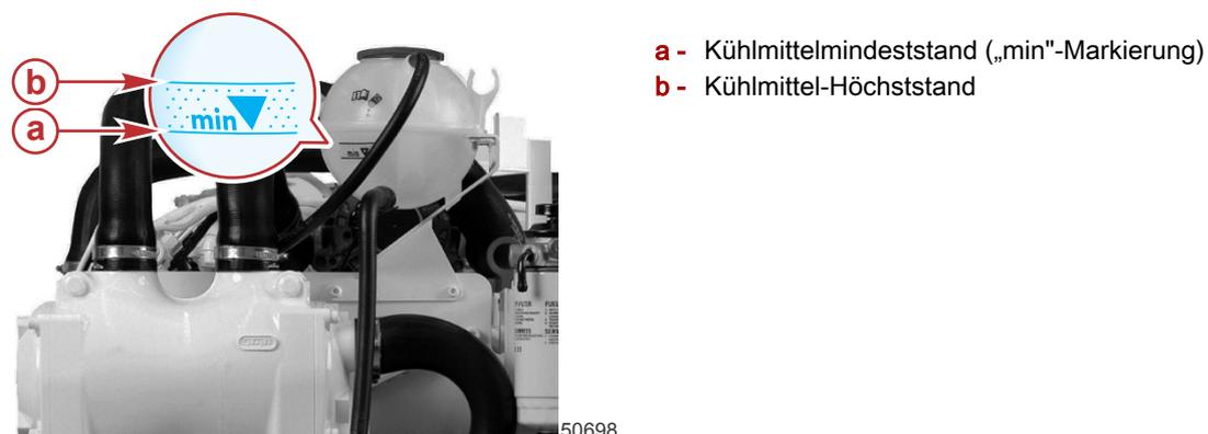
Für einen einwandfreien Motorbetrieb muss das Kühlmittel innerhalb des Zweikreiskühlsystems stets auf dem richtigen Kühlmittelstand gehalten werden. Bei kaltem Motor muss der Pegel im Kühlmittelausgleichsbehälter stets zwischen der Mindest- und Höchstmarkierung stehen.
